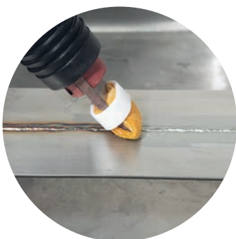
Ультразвуковая и химическая обработка швов на нержавеющей стали
